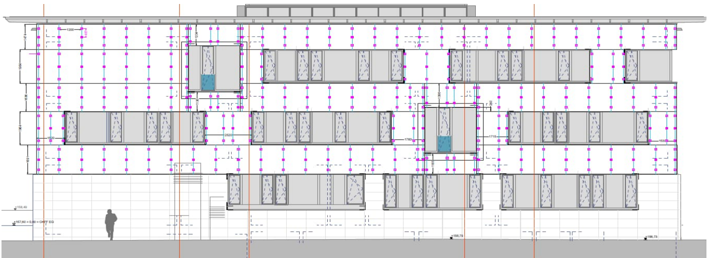
Verlegeplan der zertifizierten Komponente an der Referenzfassade
